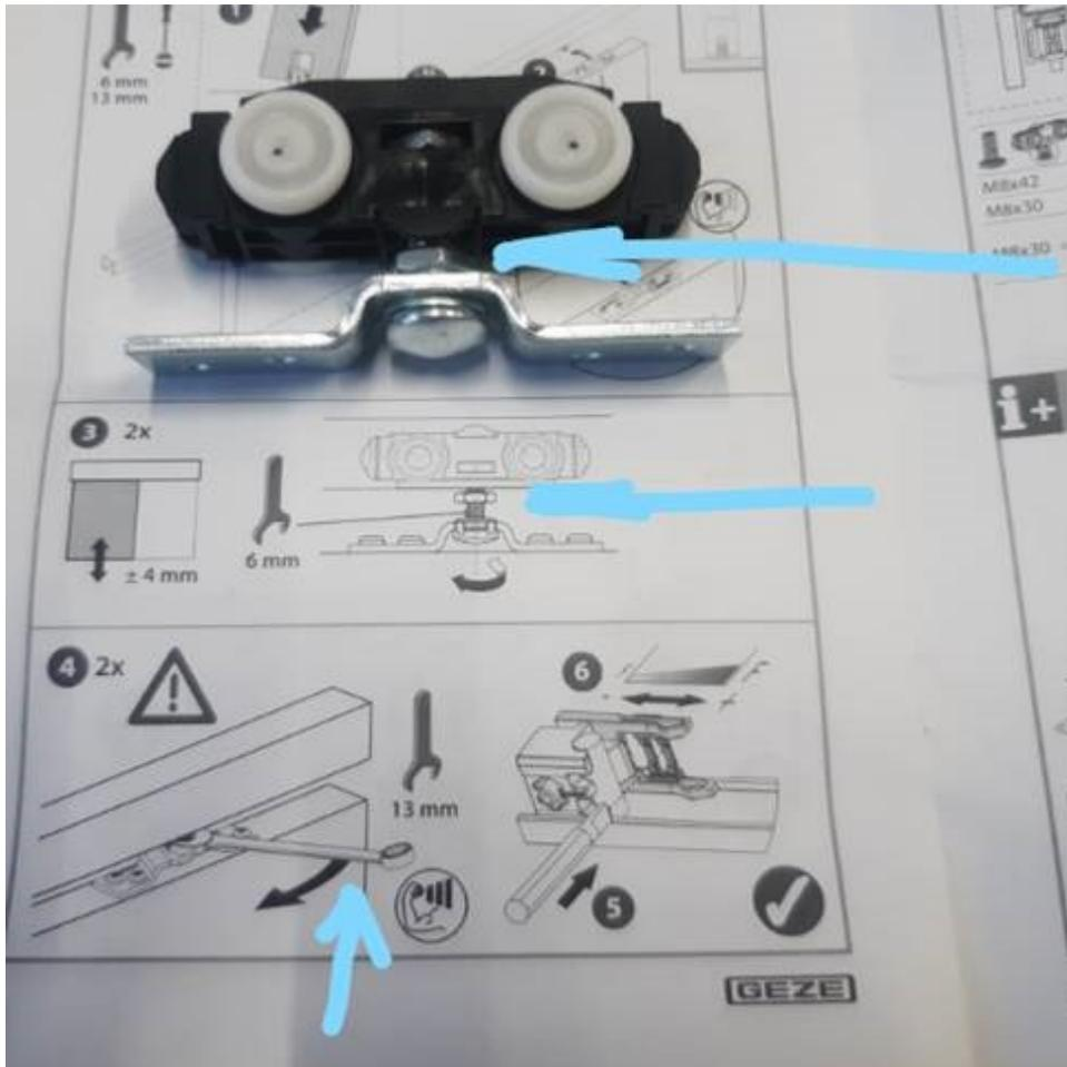
(NL) Aan de onderkant van elke schuifdeur is kunststof beslag bevestigd - verstelbare vloergeleider-. Met behulp van de schroef kunt u instellen hoe gemakkelijk (hoe vrij) de deur langs de onderste rail zal glijden.
