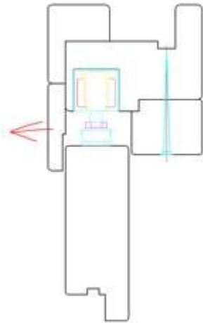
2. (NL) We zien nu zo'n schuifmechanisme (het plastic deel met wieltjes bevindt zich op een aluminium rail en is niet zichtbaar, de onderste gebogen metalen plaat is vastgeschroefd aan de bovenkant van de deur).
